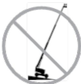
Ne pas se fier à l'alarme de dévers pour indiquer le niveau. L'alarme de dévers retentit dans la nacelle uniquement lorsque la machine se trouve sur une pente à forte inclinaison.
