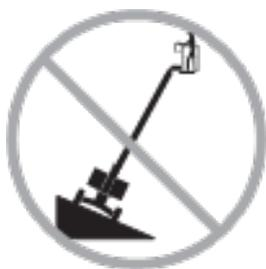
Ne pas relever ni étendre la flèche tant que la machine n'est pas sur une surface ferme et plane.
