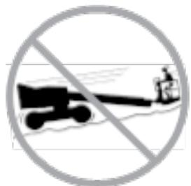
Adapter la vitesse de déplacement en fonction de l'état du sol, de la circulation, de l'inclinaison, de l'emplacement du personnel et de tout autre facteur susceptible de provoquer une collision.
