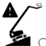
Le témoin d'inclinaison de la machine est allumé : le témoin est allumé et l'alarme de dévers retentit lorsque la machine dépasse les paramètres d'activation du capteur de dévers. Suivre la procédure appropriée ci-dessous et placer la machine sur une surface ferme et plane.
