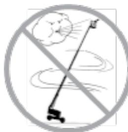
Ne pas relever la flèche lorsque la vitesse du vent peut dépasser 28 mi/h / 12,5 m/s. Si la vitesse du vent est supérieure à 28 mi/h / 12,5 m/s lorsque la flèche est relevée, abaisser la flèche et arrêter immédiatement la machine.
