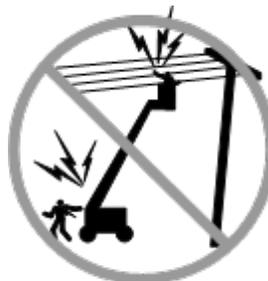
Rester éloigné de la machine si elle touche des lignes sous tension. Le personnel au sol ou à bord de la nacelle ne doit ni toucher, ni utiliser la machine tant que les lignes électriques sont sous tension.
